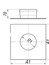
Площадка торцевая применяется в вытяжных системах для присоединения трубы к общему вентиляционному каналу.
