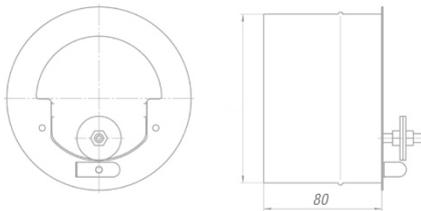
Стабилизатор тяги служит для поддержания оптимальной величины вытяжного воздуха. Минимизирует теплопотери и увеличивает коэффициент полезного действия отопительного оборудования.
