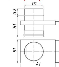
Шибер предназначен для регулирования тяги внутри дымохода.
