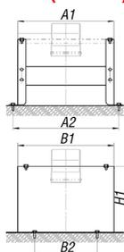
Опора напольная является несущим силовым элементом. Принимает на себя вес вышерасположенной конструкции и переносит его на фундамент.
