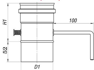
Шибер предназначен для регулирования тяги внутри дымохода.
