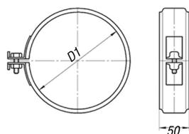
Хомут предназначен для крепления элементов дымохода между собой.
