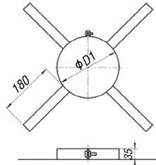
Хомут применяется для установки дымоходна в канал с большим сечением.
