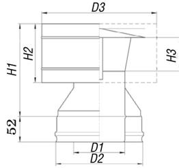
Дефлектор предназначен для предотвращения появления противотяги в дымоходе при сильном боковом ветре. Дефлектор на двустенный дымоход выполняется из двух изделий: 1ДП и 2КСМ и соединяются между собой хомутом.
