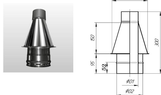
Наконечник предназначен для забора воздуха во внешний контур коаксиального дымохода.
