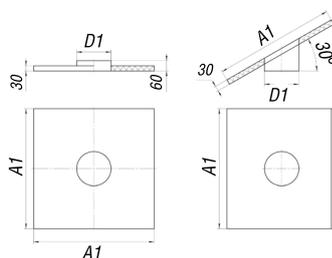
Фланец предназначен для закрытия места прохода дымохода через межэтажные перекрытия. Выполнен в виде короба с фланцем под диаметр трубы. Короб заполнен базальтовой ватой.
