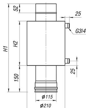
Теплообменник устанавливается на дымовой патрубок банной печи, подключается к навесному баку, где за счет естественной циркуляции происходит нагрев воды.
