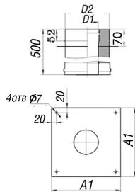
Изделие предназначено для переноса веса вышерасположенной конструкции на междуэтажное перекрытие.
