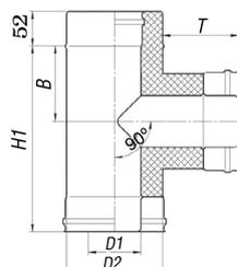
Тройник предназначен для соединения дымоотвода с основным каналом дымохода. При установке тройника на повороте дымохода из горизонтального или наклонного положения в вертикальное в нижней части тройника устанавливается заглушка или конденсатоотвод.
