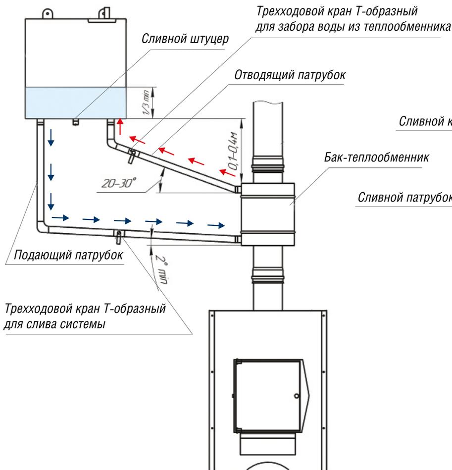
СХЕМА МОНТАЖА БАКА ДЛЯ ПЕЧИ С ТРУБОЙ
