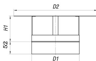
Грибок предназначен для предотвращения попадания осадков внутрь дымохода, грибок с искрогасителем – также препятствует попаданию искр на кровлю. Являются завершающими элементами дымового канала.
