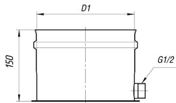
Конденсатоотвод предназначен для отведения влаги (конденсата) из конструкции дымохода.
