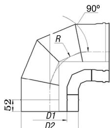
Отвод позволяет выполнять отклонения дымохода от прямолинейной траектории.
