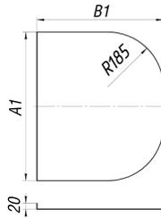
Притопочный лист используется для обеспечения пожарной безопасности напольной зоны перед топочной частью печи или котла.
