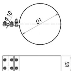
Хомут предназначен для крепления токоотводов к дымоходу.
