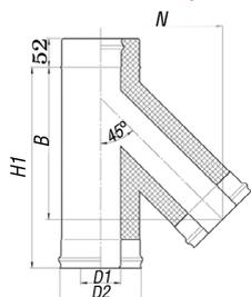
Тройник предназначен для соединения дымоотвода с основным каналом дымохода. При установке тройника на повороте дымохода из горизонтального или наклонного положения в вертикальное в нижней части тройника устанавливается заглушка или конденсатоотвод.
