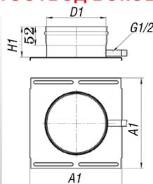
Конденсатоотвод предназначен для отведения влаги (конденсата) из конструкции дымохода.
