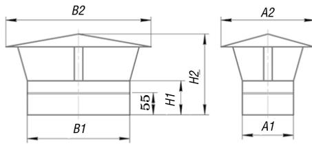
Зонт используется для предохранения эллиптического дымохода от атмосферных осадков, является завершающим элементом.
