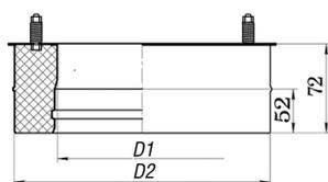
Заглушка предназначена для недопущения разрушения теплоэнергетической установки в случае взрыва горючих газов, а также препятствует деформации конструкции дымохода в момент взрыва.
