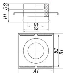
Монтажная площадка закрепляет дымоход, поддерживая его конфигурацию, и переносит нагрузку монтируемых на ней модулей на несущую конструкцию.
