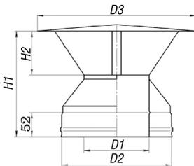
Оголовок используется для того, чтобы защитить дымоход от попадания в него жидкости, задувания ветра и т.д.
