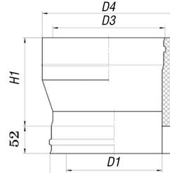
Переход применяется для соединения участков дымоходов с различными диаметрами.
