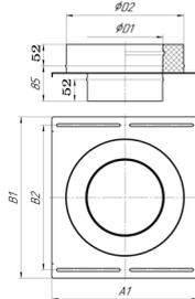
Площадка используется для перехода с одностенного дымохода на двустенный дымоход, устанавливается на консоль.
