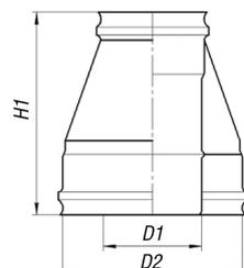
Конус устанавливается на окончание дымохода и защищает слой термоизоляции от попадания атмосферных осадков.
