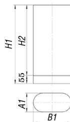
Одностенная труба эллиптическая – это главный элемент дымоходной системы. Основное предназначение трубы – отведение газов и продуктов горения на прямых участках. Одностенные дымоходные трубы универсальны по применению к отопительным системам на различном виде топлива. Трубы монтируются как внутри помещений, так и внутри кирпичных дымоходов. Стандартная длина – 1000, 500 и 250 мм.
