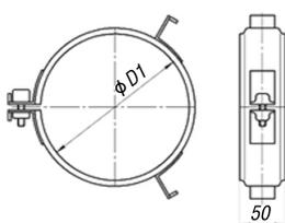
Хомут используется для фиксации наружной части дымоходной конструкции. Растяжка для дымохода представляет собой разъемный элемент с петлями для закрепления стальных растяжек.
