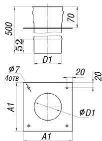
Изделие предназначено для переноса веса вышерасположенной конструкции на междуэтажное перекрытие.
