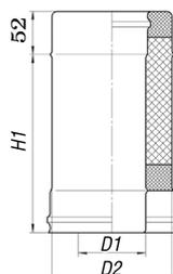
Сэндвич труба используется для организации безопасного дымохода, который отводит продукты горения от котла, работающего на твердом, жидком топливе или газе. Основная особенность сэндвич трубы – это наличие теплоизоляции между внутренней и внешней трубой.
