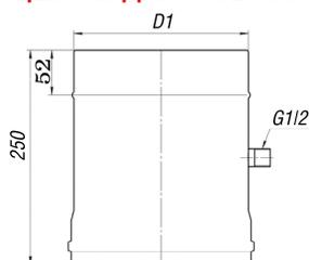
Труба оснащена штуцером для забора газов.
