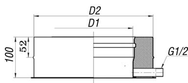
Конденсатоотвод используется для отведения конденсата из конструкции дымохода.
