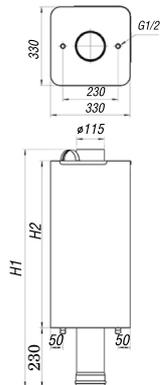
Бак устанавливается на дымовой патрубок банной печи, предназначен для нагрева воды в бане.
