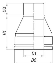
Изделие используется для перехода с двустенного дымохода на одностенный дымоход.
