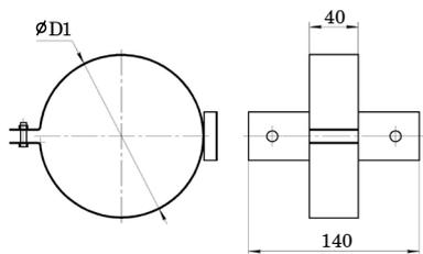
Хомут применяется для крепления дымохода к стене, препятствует смещению дымохода в горизонтальной плоскости.
