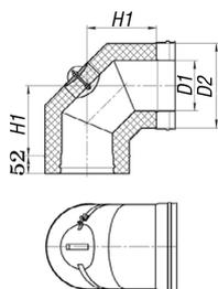
Отвод позволяет выполнять отклонения дымохода от прямолинейной траектории, а также предназначен для очистки дымохода.
