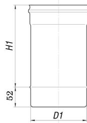
Одностенная труба – это главный элемент дымоходной системы. Основное предназначение трубы – отведение газов и продуктов горения на прямых участках. Одностенные дымовые трубы универсальны по применению к отопительным системам на различном виде топлива. Трубы монтируются как внутри помещений, так и внутри кирпичных дымоходов. Стандартная длина – 1000, 500 и 250 мм.
