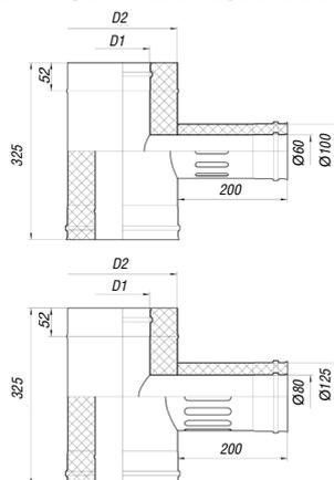
Тройник с коаксиальным подключением служит для подключения одноконтурной системы к коаксиальному дымоходу на улице или в шахте.
