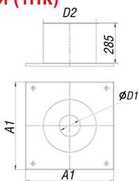
Потолочно-проходной узел используется для прохождения потолочных и стеновых перекрытий и для защиты их от перегрева.
