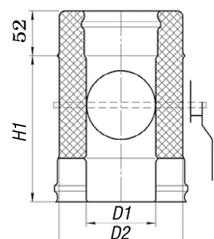
Шибер предназначен для регулирования тяги внутри дымохода.
