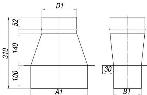
Переходник применяется для соединения кирпичного дымохода с одностенным стальным дымоходом.
