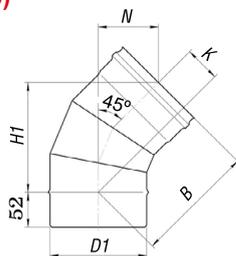
Отвод позволяет выполнять отклонения дымохода от прямолинейной траектории.
