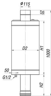
Бак устанавливается на дымовой патрубок банной печи, предназначен для нагрева воды в бане. Возможно изготовление баков с диаметром трубы от 110 до 150 мм.
