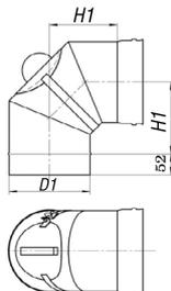
Отвод позволяет выполнять отклонения дымохода от прямолинейной траектории, а также предназначен для очистки дымохода.
