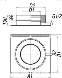
Конденсатоотвод используется для отведения конденсата из конструкции дымохода, устанавливается на опору напольную.
