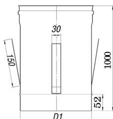
Труба предназначена для центрования трубы в шахте дымохода.
