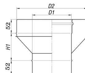
Изделие используется для перехода с одностенного дымохода на двустенный дымоход.
