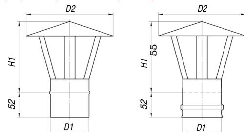
Зонт используется для предохранения одностенного дымохода от атмосферных осадков, является завершающим элементом дымового канала.
