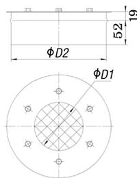
Заглушка предназначена для недопущения разрушения теплоэнергетической установки в случае взрыва горючих газов, а также препятствует деформации конструкции дымохода в момент взрыва.
