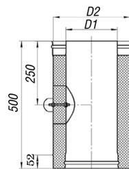
Труба предназначена для очистки дымохода.
