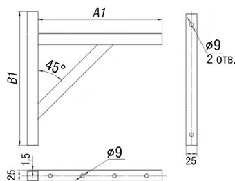
Консоль является опорным элементом для монтажной площадки. Изготовлена из профильной трубы.
