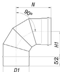
Отвод позволяет выполнять отклонения дымохода от прямолинейной траектории.
