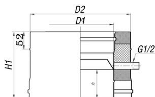
Конденсатоотвод используется для отведения конденсата из конструкции дымохода.
