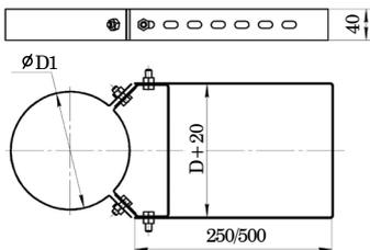
Кронштейн применяется для крепления дымохода к стене, препятствует смещению дымохода в горизонтальной плоскости. Изготавливается в удлиненном варианте.
