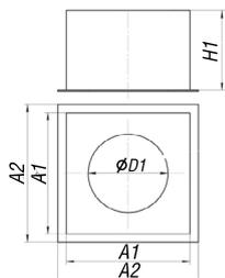
Потолочно-проходной узел используется для прохождения потолочных и стеновых перекрытий и для защиты их от перегрева.
