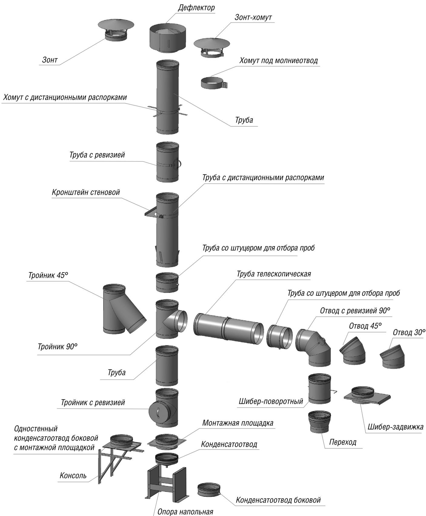
Одностенные дымоходы являются наиболее простым решением при монтаже дымового канала. Все детали этого дымохода соединяются по раструбной системе. Также они используются как внутренние трубы двустенных дымоходов.
