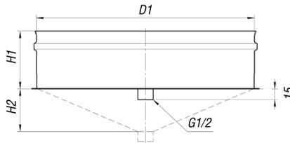
Конденсатоотвод предназначен для отведения влаги (конденсата) из конструкции дымохода.
