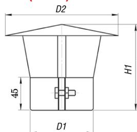
Зонт используется для предохранения одностенного дымохода от атмосферных осадков, является завершающим элементом дымового канала.
