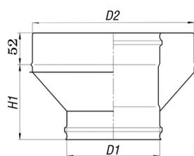
Изделие используется для перехода с одностенного дымохода на двустенный дымоход.
