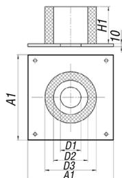
Потолочно-проходной узел используется для прохождения потолочных и стеновых перекрытий и для защиты их от перегрева.
