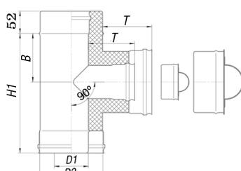
Тройник предназначен для обслуживания дымохода.
