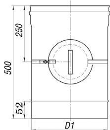
Труба предназначена для очистки дымохода.
