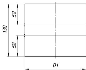
Адаптер П применяется в качестве соединительного элемента дымохода с котлом или печью. Элемент также используется для стыковки одностенных дымоходов с другими.
