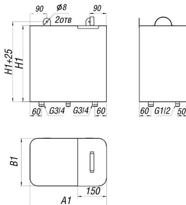
Бак навесной подключается к баку-теплообменнику или встроенному теплообменнику банной печи.
