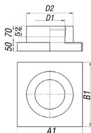
Площадка служит для перехода с кирпичного дымохода на двустенный стальной дымоход; толщина площадки 1,5 мм.
