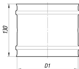
Адаптер М используется как промежуточный стартовый элемент между отопительным аппаратом и дымоходом.
