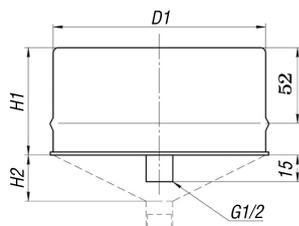
Конденсатоотвод используется для отведения конденсата из конструкции дымохода.
