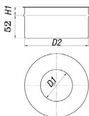
Заглушка предназначена для обслуживания дымохода, закрывает только его утепленную часть.
