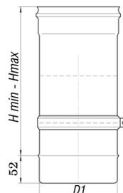
Телескопическая труба – это модуль с возможностью изменения длины элемента. Применяется для компенсации тепловых расширений, корректировки длины прямых участков дымохода для соблюдения заданной в проекте геометрической конфигурации, компенсации осадки деревянного (особенно бревенчатого) дома.
