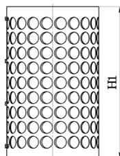
Крепится на одностенную дымовую трубу. Предназначена для заполнения камнями, снижает влияние жесткого излучения от металла трубы, позволяет получить больший объем пара.
