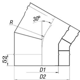
Отвод позволяет выполнять отклонения дымохода от прямолинейной траектории.
