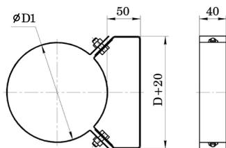
Кронштейн применяется для крепления дымохода к стене, препятствует смещению дымохода в горизонтальной плоскости.
