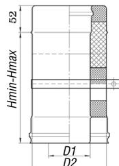
Телескопическая труба — это модуль с возможностью изменения длины элемента. Применяется для компенсации тепловых расширений, корректировки длины прямых участков дымохода для соблюдения заданной в проекте геометрической конфигурации, компенсации осадки деревянного (особенно бревенчатого) дома.
